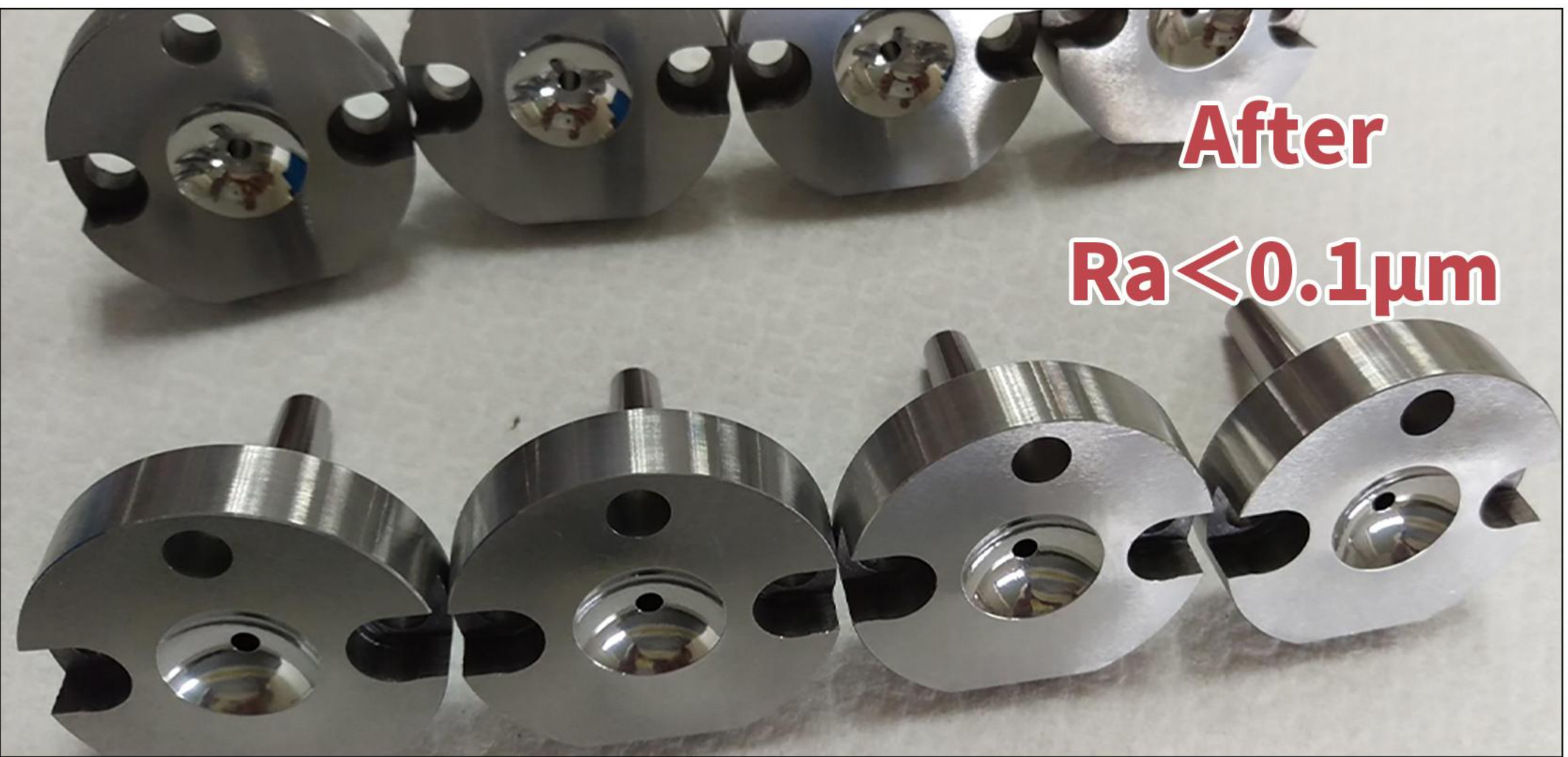
SKD61射出噴嘴線切割+噴射拋光
