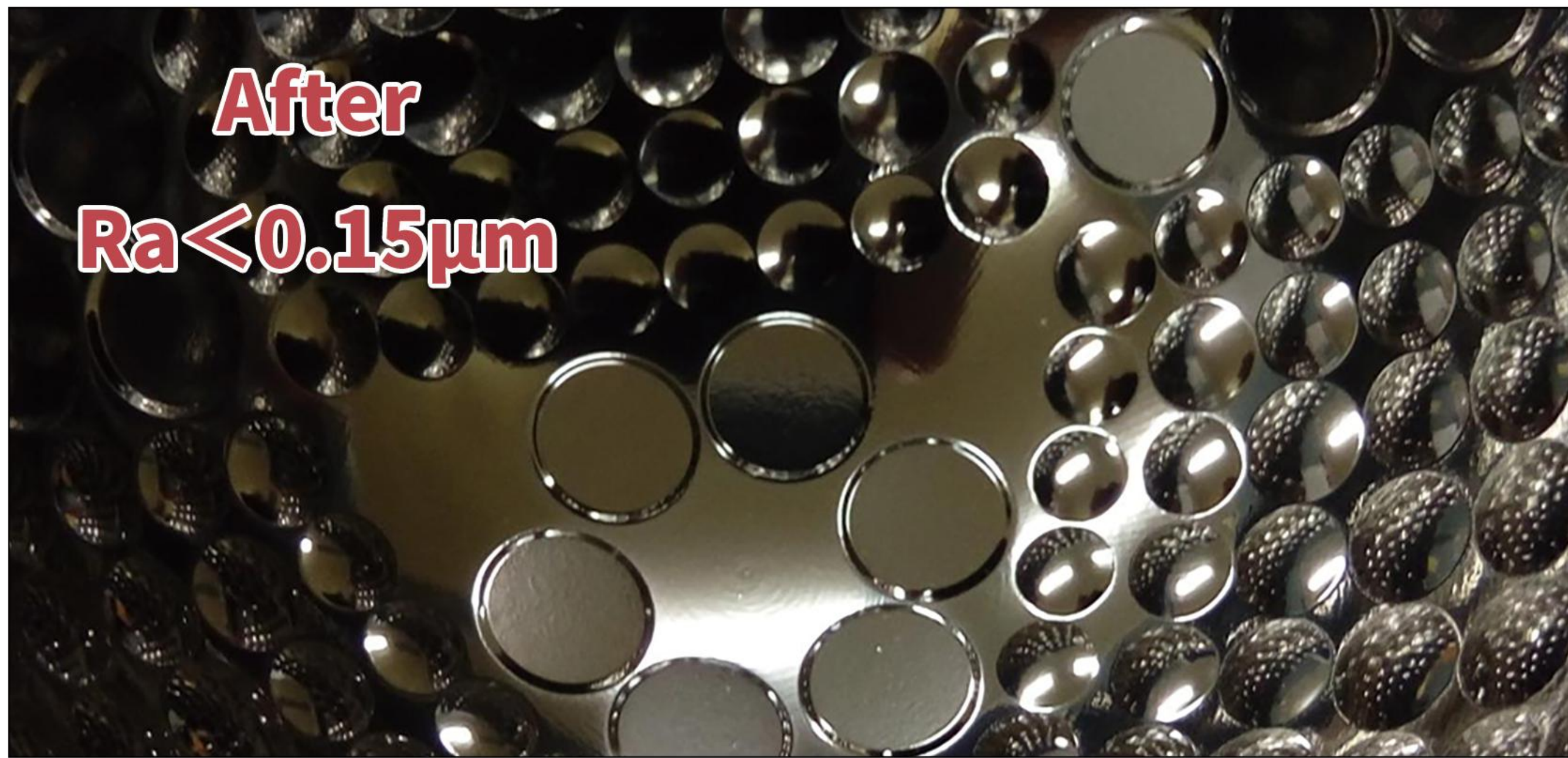
高硬度(HRC64) CNC銑削+鏡面噴射拋光
